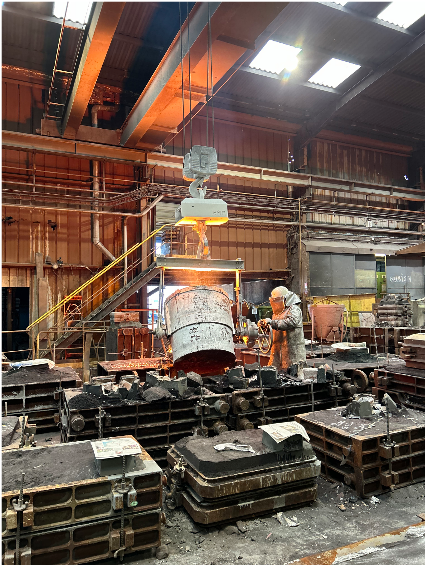
Productie van de (de Forest) Radiator bar 1 en 2, Fonderies de la Scarpe. Foto: Jeanne Mouffe
